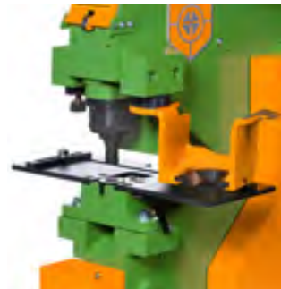
dispositivo de cambio rápido de punzonado
