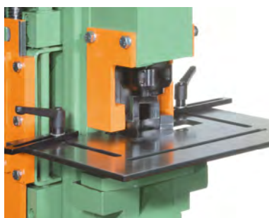
703 en la entalladora : dispositivo especial para el punzón no. 7, matriz no. 6, equipado con punzón y matriz para redondear esquinas de R= 35 mm
