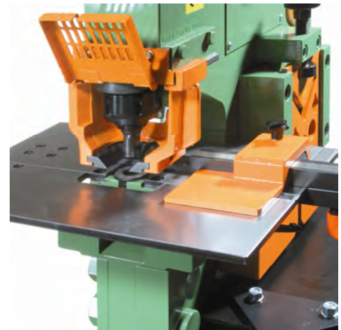
Material-Auflagetisch, mit mm-Teilung und steckbarem Auflagefeld an der Vorderseite, 500 x 405 mm, zur Normal-Stanzvorrichtung Kenn-Nr. 548
