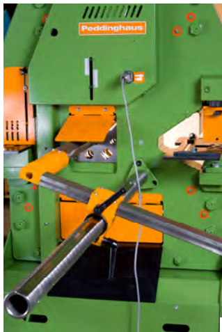
Elektrischer Universal-Längenanschlag, für 1 Meter Abschnittlänge Kenn-Nr. 522.1
