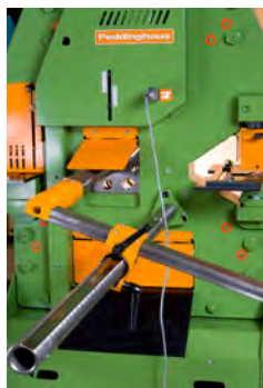
522 elektrischer Längenanschlag 1 Meter 2 Meter 3 Meter
